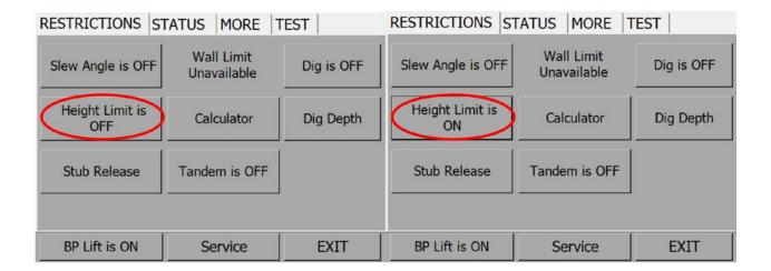
**WARNING:** THE HEIGHT RESTRICTION FUNCTION IS DESIGNED TO BE USED AT SLOW LIFT SPEEDS ONLY. USE AT SPEED MAY RESULT IN AN OVERSHOOT INTO A POTENTIALLY DANGEROUS POSITION.
